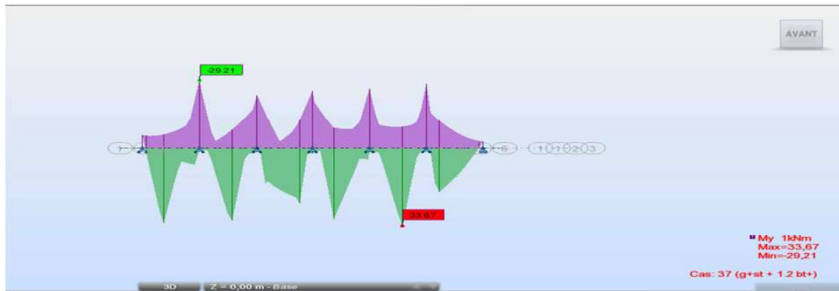
Figure VII- 7 le moment max a els ( G+st+1.2 bt )
