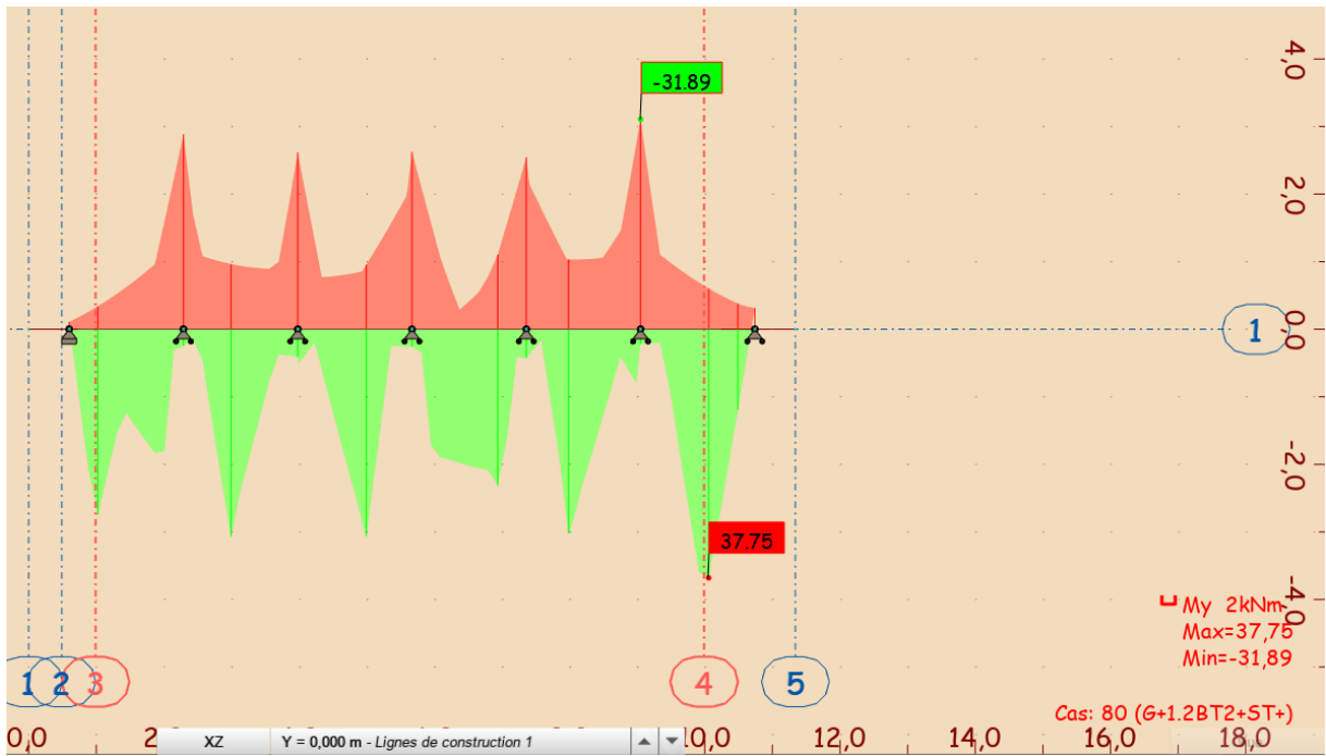
Figure V.1 : Moment max à l'ELS – Dalle
