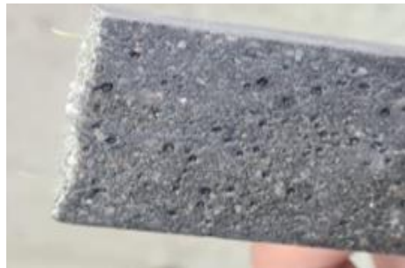
Figure I.5 Mortier durci avec l'aramide
