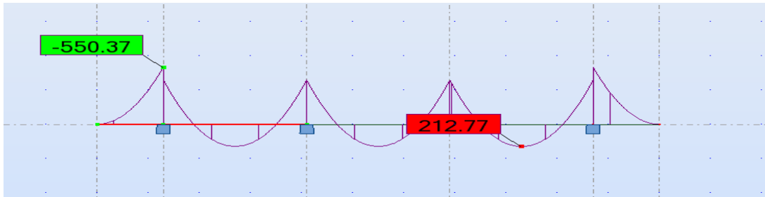
Figure VIII.9. Moment max à l'ELS sous la combinaison G+D240
