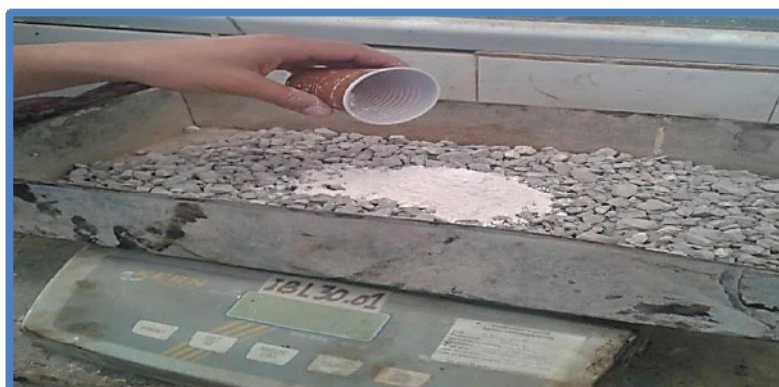
Figure 53: Ajouter la chaux hydratée au mélange
