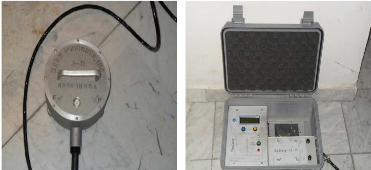
Figure IV.1 : Matériel d'acquisition des mesures de bruit de fond structure. À droite : la station CitysharkI à gauche ; .le capteur vélocimètre 2s.
