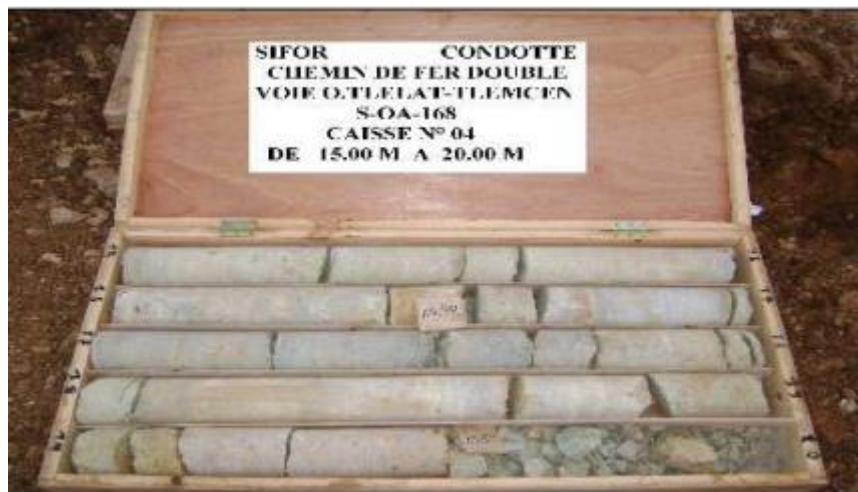
Caisse 4 de 15.00 à 20.00 m
