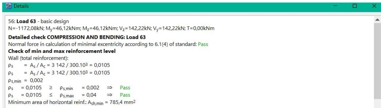
Figure VIII.1 : Détails du calcul de compression-flexion et vérification du taux minimal et maximal d'armatures sous FIN EC 2020.
