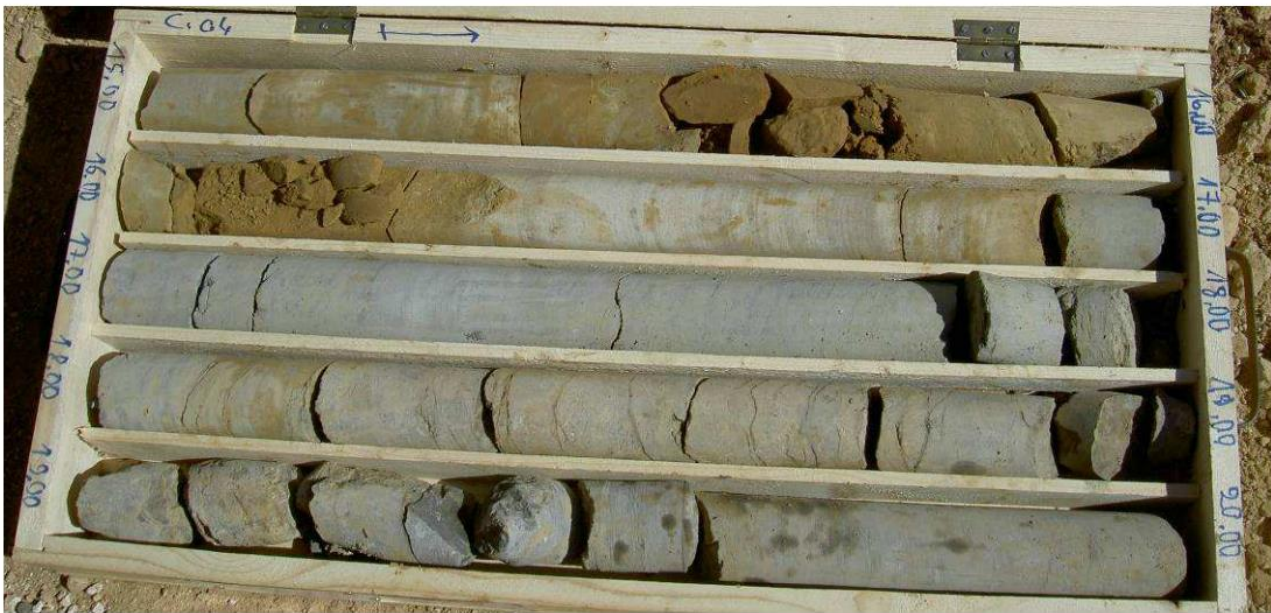
Sondage S-OA-167 - pk 125+825 Caisse 4 - Profondeur 15.00 – 20.00m
