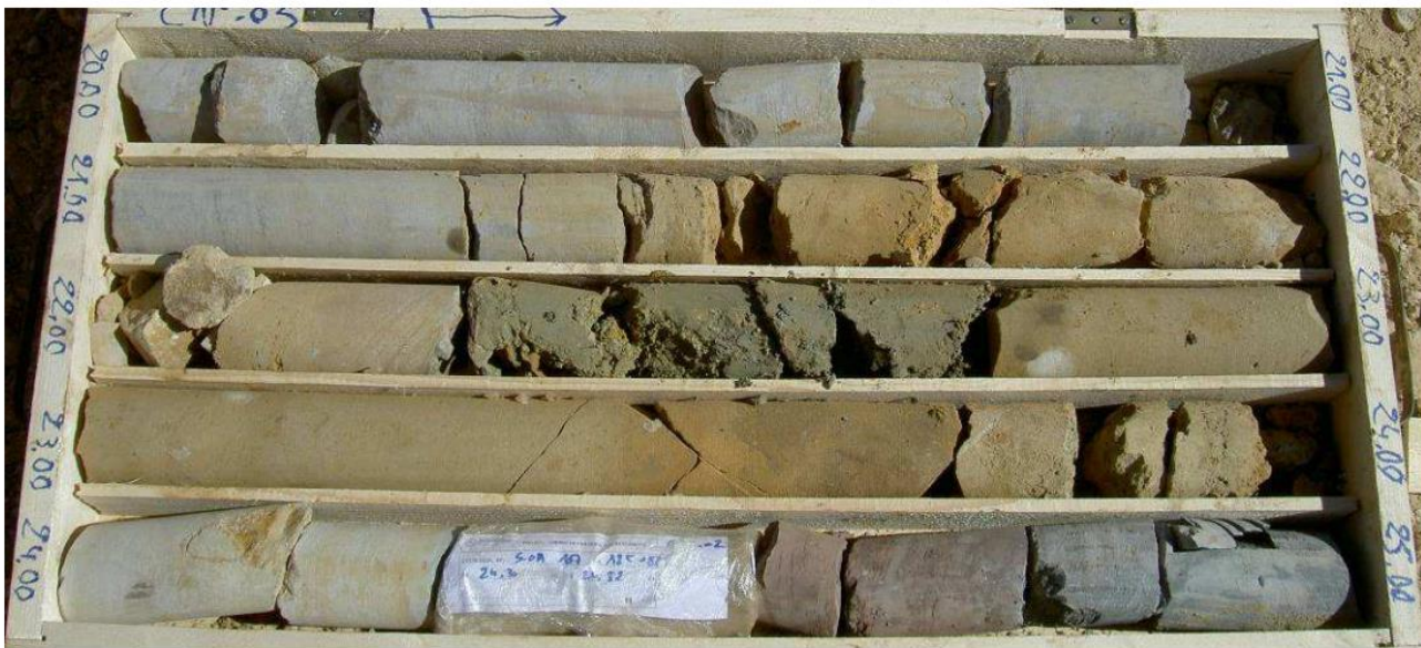
Sondage S-OA-167 - pk 125+825 Caisse 5 - Profondeur 20.00 – 25.00m
