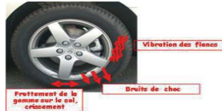
Figure. I.2.5. Bruit dû aux vibrations du Pneumatique.
