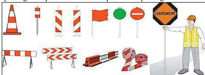
Figure XII.3. Signalisation sur chantier.
