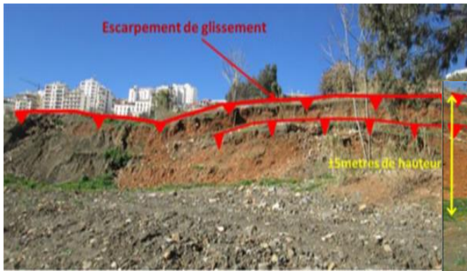
Figure III.5. Escarpement principal de glissement
