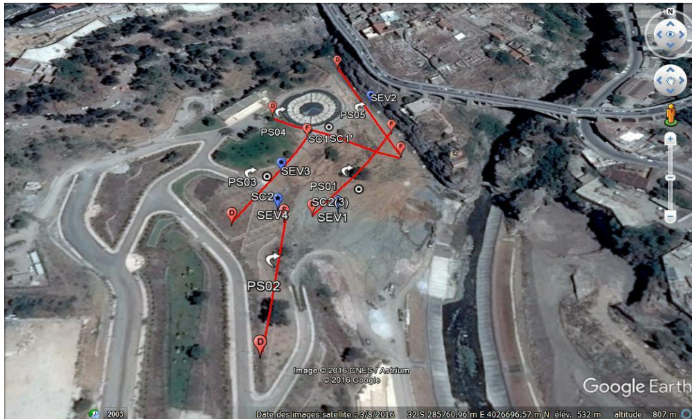
Figure IV.2. Implantation des profils géophysiques
