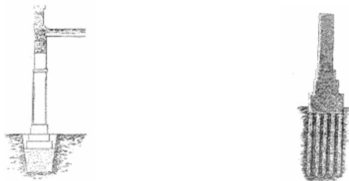
a- Pilier fondé sur massif de sable
