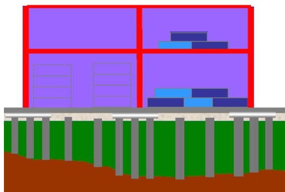
Figure 3.11- Dallages et fondations de bâtiments industriels
