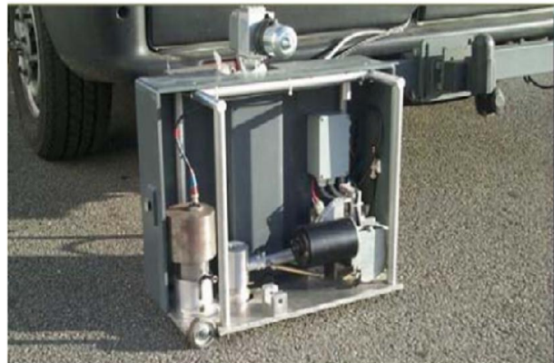
Figure III-3: Principe des méthodes d'auscultation dynamique et prototype COLIBRI du LCPC
