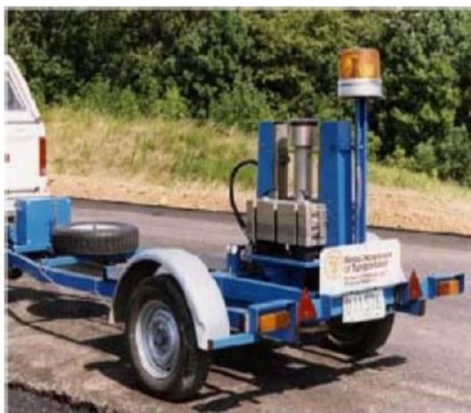
Figure III-2: Appareillage et principe de fonctionnement du FWD ( www.infralab.ch )
