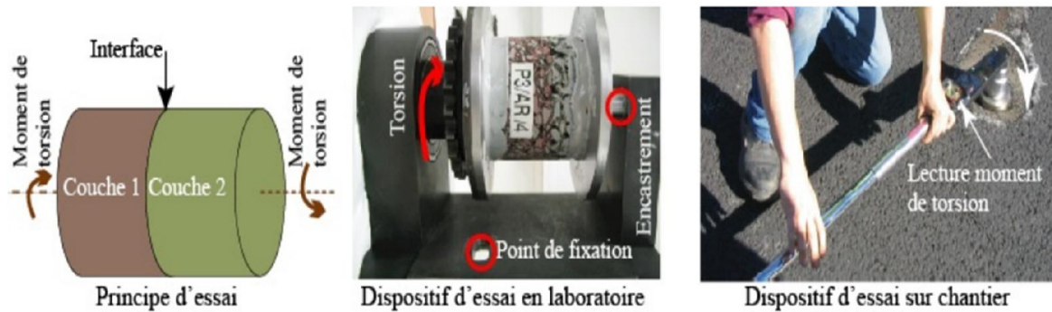
Figure III-6: Essai de torsion : principe d'essai et exemples de dispositifs d'essai (CRM Eurovia)
