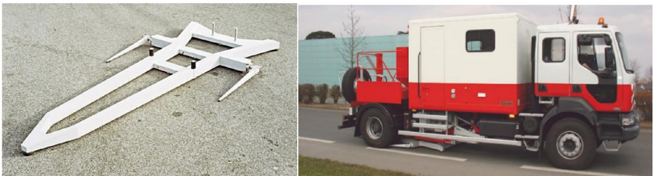
Figure III-1: Mesure de déplacement vertical par le déflectographe
