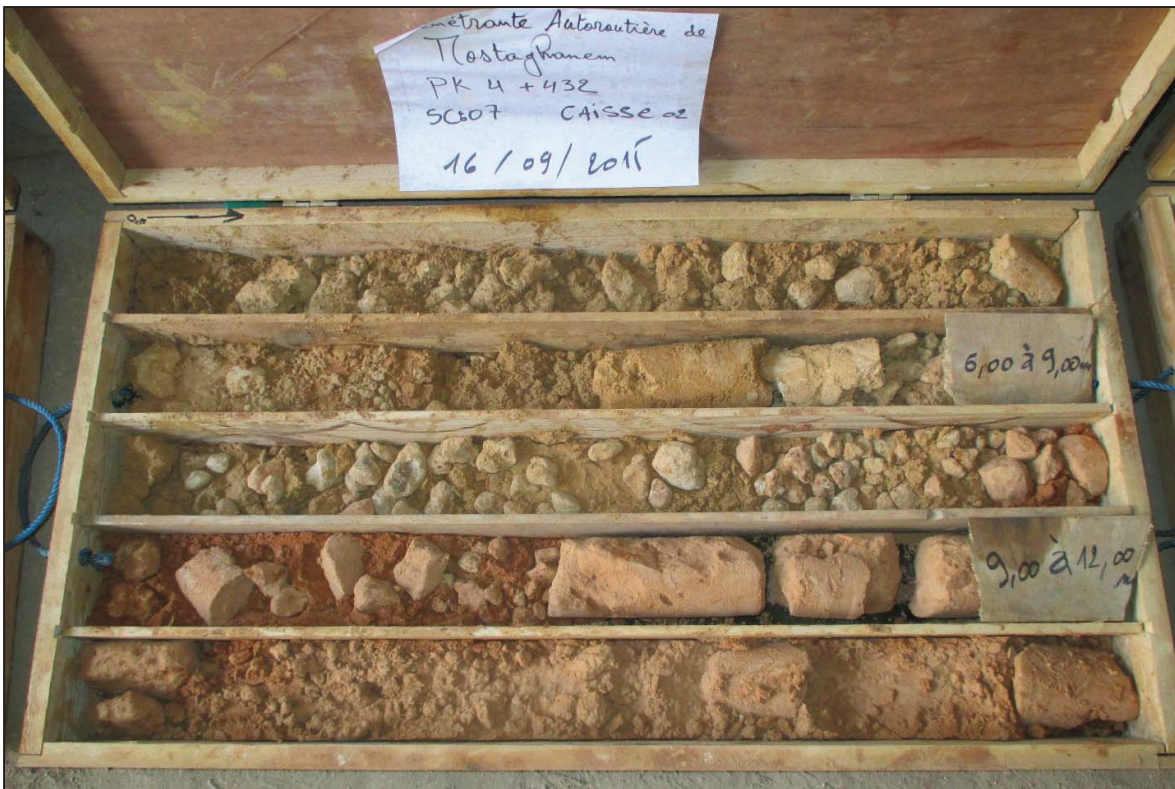
Client : COSIDER ENGINEERING Projet : Liaison autoroutière de Mostaganem à l'autoroute Est-ouest Sondage : OA 4 – PK 04+432 - SC07 - Caisse n° : 2/3 Profondeur : 6,00 à 13,00 m
