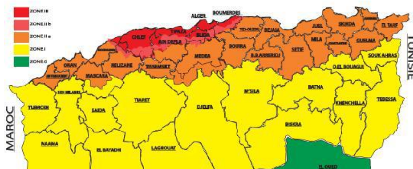
Figure II-5 : Cartes de zonage sismique de l'Algérie (RPA99 / version 2003).
