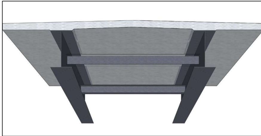
Figure II.3. Conception transversale du tablier.
