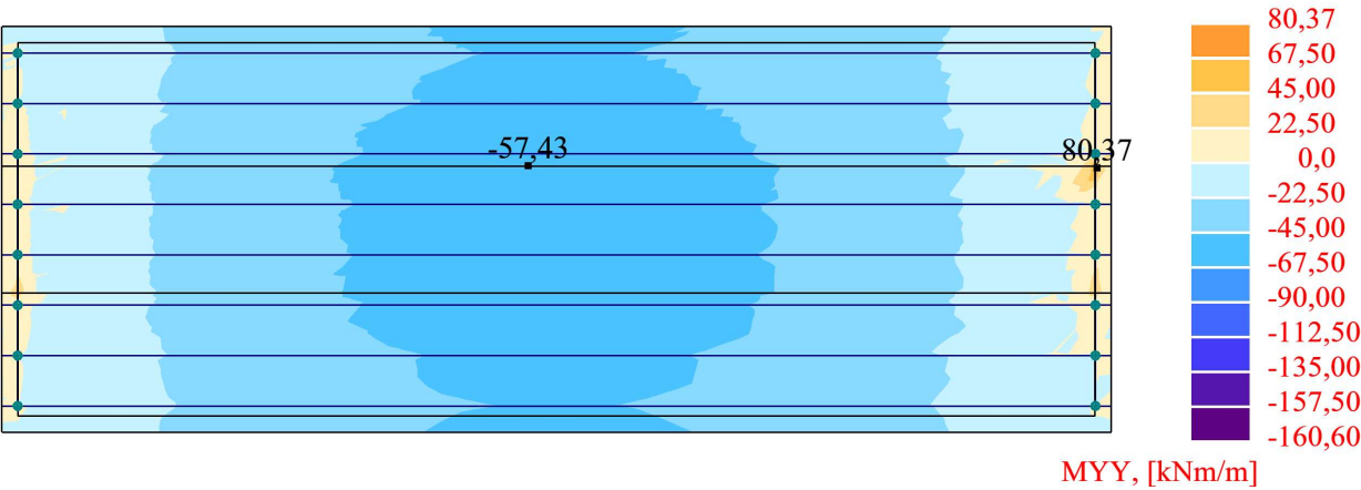
Figure VII.9. Moment max de la dalle à l'ELU .
