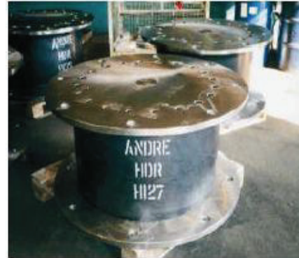
Figure I.4. Photo et schéma d'un isolateur en élastomère d'amortissement élevé (HDRB).
