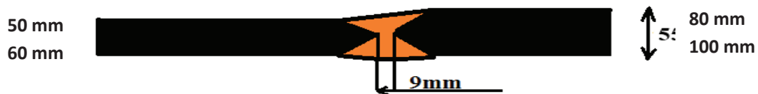
Figure. VII.22. Un chanfreiné en X des semelles inférieures.
