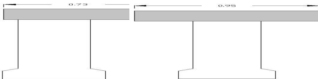
FIGURE 6-1 : Poutre de l'intermédiaire et poutre de rive
