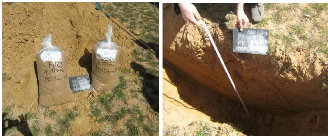
Figure9.1 puits de reconnaissance
