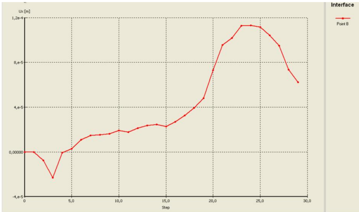
Figure III.20 Courbe charge-déplacement horizontal à l'interface sol-pieu
