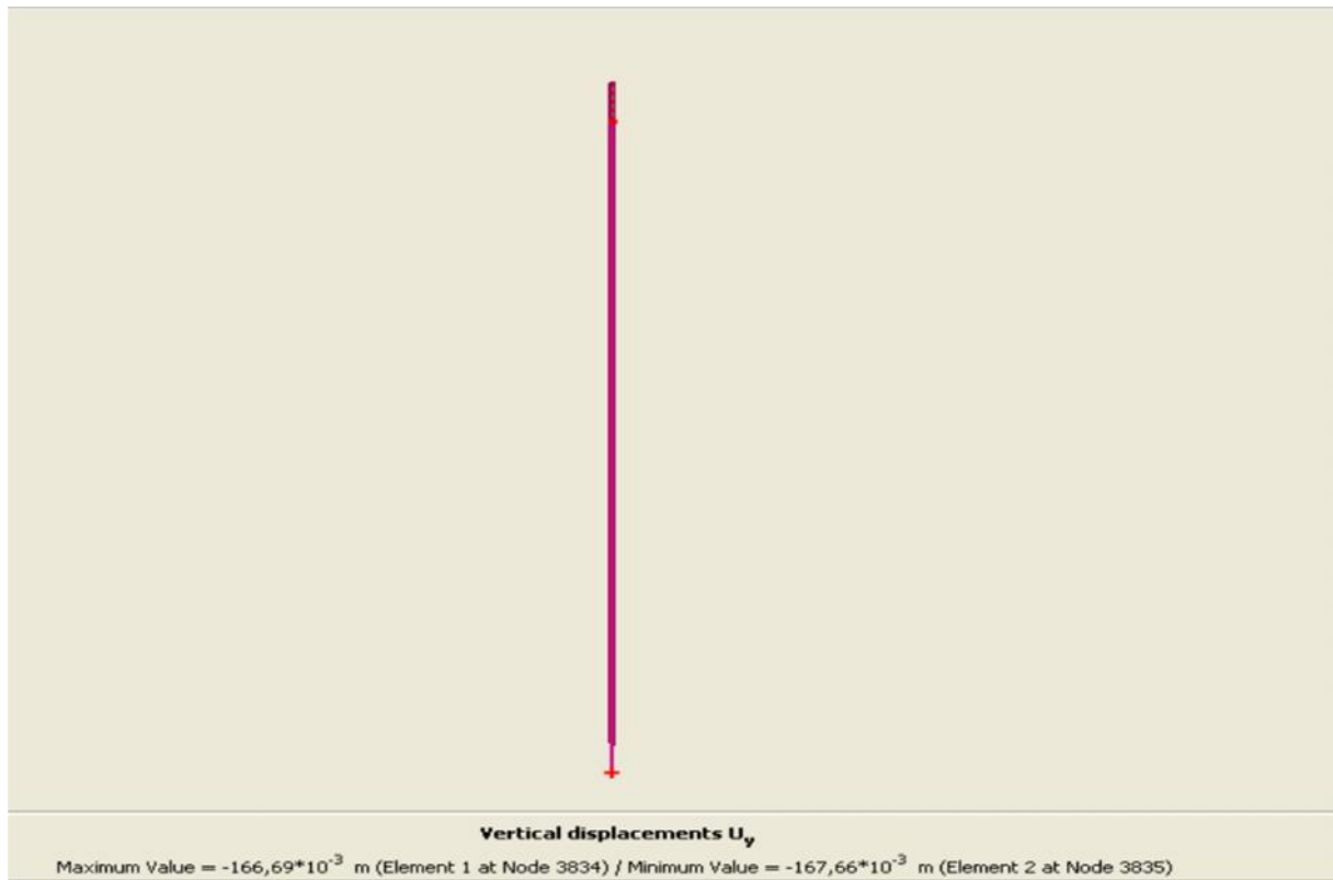
Figure III.16 Déplacement vertical du pieu
