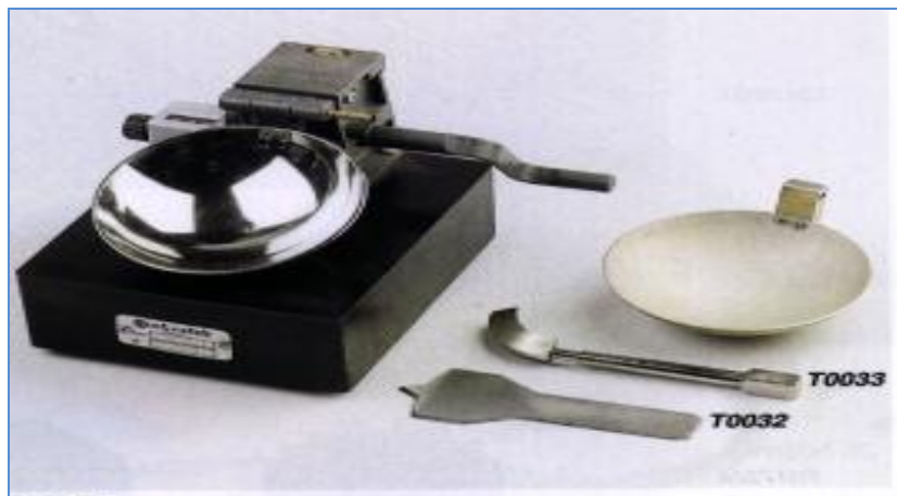
Schématisation de l'appareil de Casagrande
