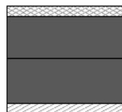
Figure 1.3 Coupe d'une structure de chaussée bitumineuse épaisse
