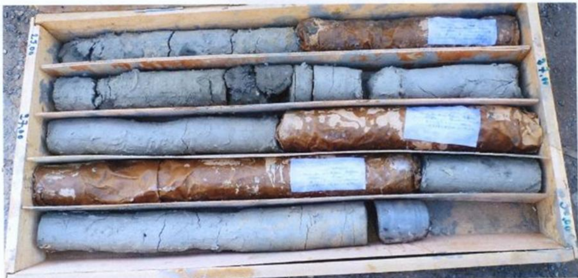
VIADUC SUR Oued Reghaia (RN24) Sondage SC2 Caisse N°3 :25.00 – 30.00m
