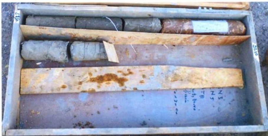
VIADUC SUR Oued Reghaia (RN24) Sondage SC2 Caisse N°5 :28.50 – 30.00m
