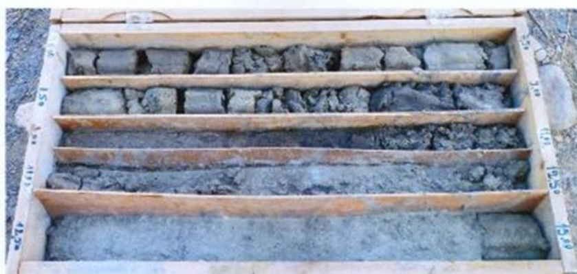
VIADUC SUR Oued Reghaia (RN24) Sondage SC1 Caisse N°2 : 6.00 – 15.00m
