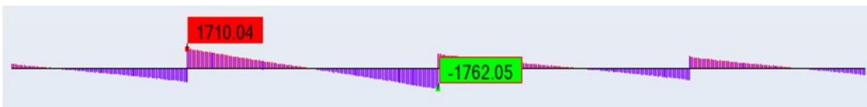
- Diagramme des efforts tranchants sous ELS 1 -
