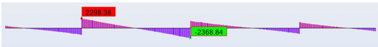
- Diagramme des efforts tranchants sous ELU 1 -
