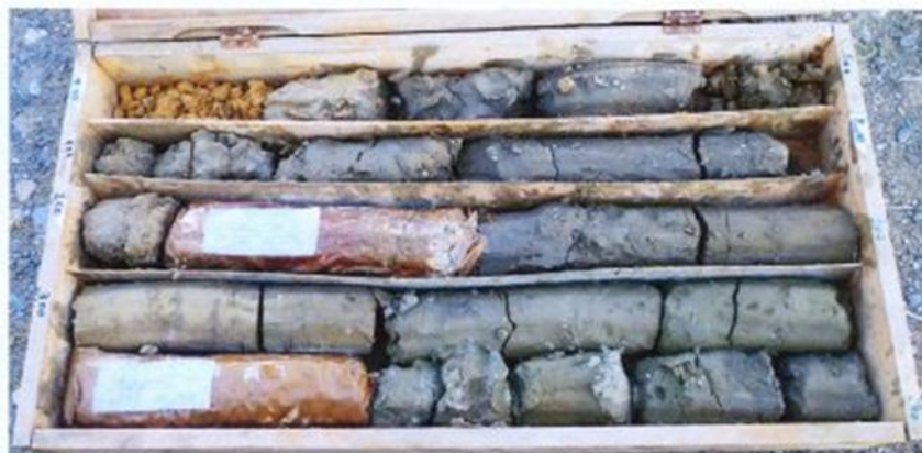
VIADUC SUR Oued Reghaia (RN24) Sondage SC1 Caisse N°1 : 0.00 – 6.00m
