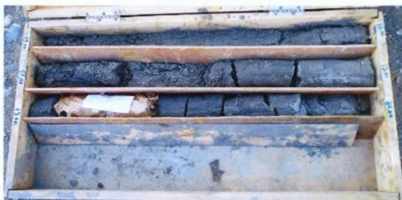
VIADUC SUR Oued Reghaia (RN24) Sondage SC1 Caisse N°3 : 15.00 – 20.00m
