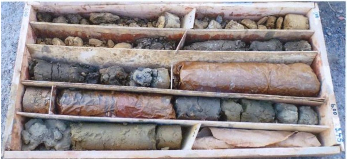
VIADUC SUR Oued Reghaia (RN24) Sondage SC3 Caisse N°1 : 0.00 – 9.45m
