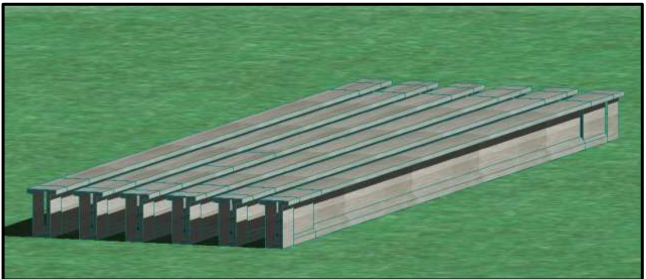
Figure VII. 1 Les 6 poutres qui constituent le tablier
