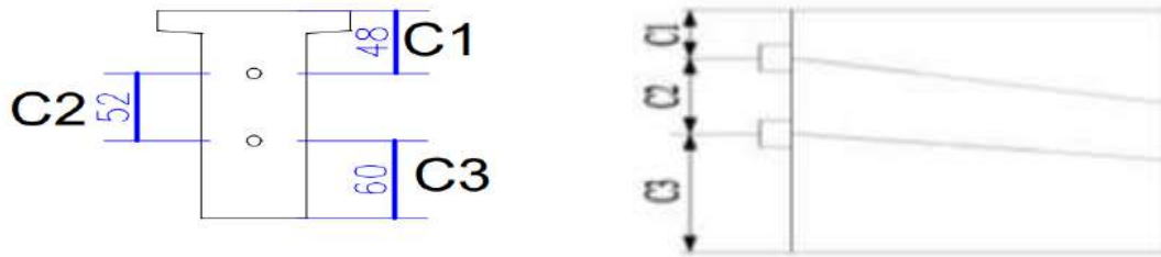
Figure VI.14: le prisme symétrique à l'Ancrage
