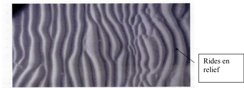
Figure (5.11) Vue de dessus d'un réseau de rides en houle bichromatique.
