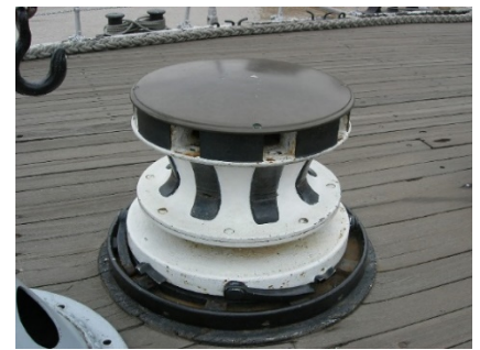
Figure III.7. Photo d'un cabestan
