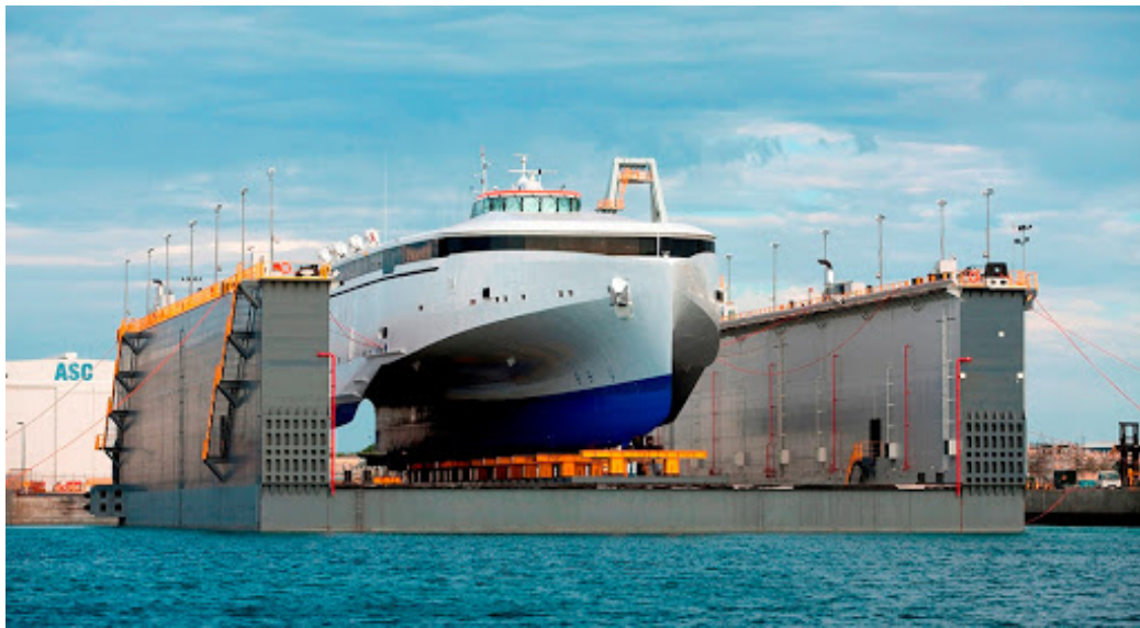
Figure III.9. Dock flottante de l'Australien marine
