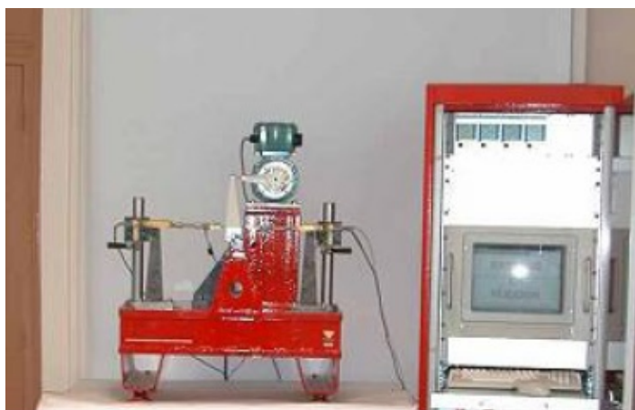
Figure 1.49. Essai de fatigue en flexion 2 points sur éprouvettes trapézoïdales [41].
