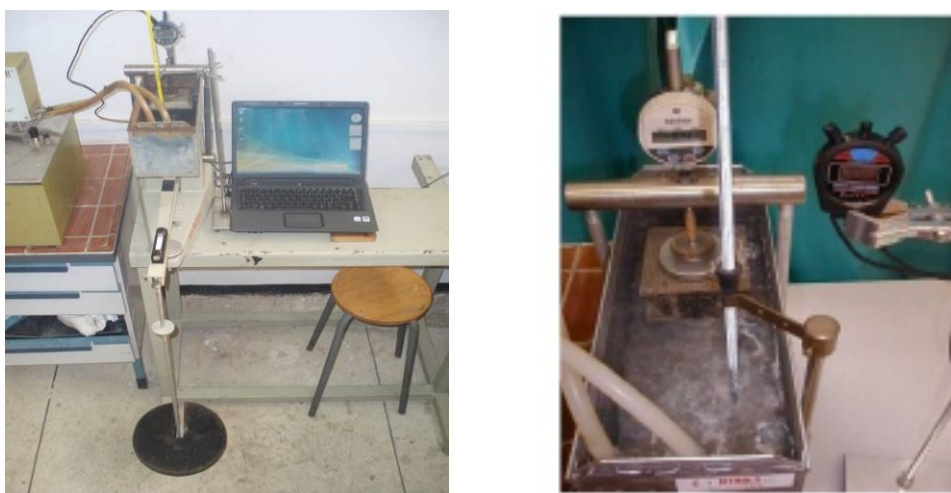
Figure 2.31. Appareillage mis au point pour l'essai de fluage - recouvrance
